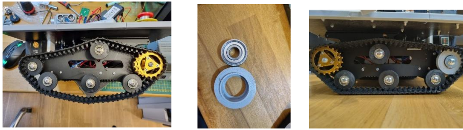
Abbildungen 3-5: -Kette vor der Anpassung/3d gedrucktes Rad und Kugellager/ Kette nach der Anpassung
